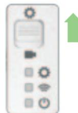
2. Versetzen Sie die NetCam in den Setup-Modus, indem Sie den Schalter an der Rückseite der Kamera nach oben drücken.
