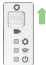
2. Coloque a NetCam no Modo de Configuração posicionando o interruptor na parte de trás da câmara em cima.
