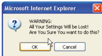
3. Die folgende Meldung erscheint. Das Wiederherstellen der Werkseinstellung erfordert einen Neustart des Routers. Dieser Vorgang kann bis zu 60 Sekunden dauern. Während des Neustarts dürfen Sie in keinem Fall die Stromversorgung des Routers abschalten.
