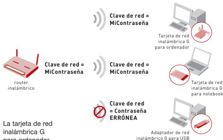
La tarjeta de red inalámbrica G para ordenador de sobremesa no puede acceder a la red porque emplea una clave de red diferente de la configurada en el router inalámbrico G.
