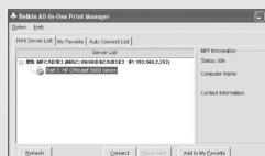
Después de que se haya completado la instalación de controladores para la impresora normal o multifunción, seleccione la casilla de la opción "Auto release when idle time is over" (Emisión automática cuando se sobrepasa el tiempo límite) en la pantalla de gestión de impresión multifunción de Belkin con un ajuste de tiempo límite de inactividad de 5 minutos.
